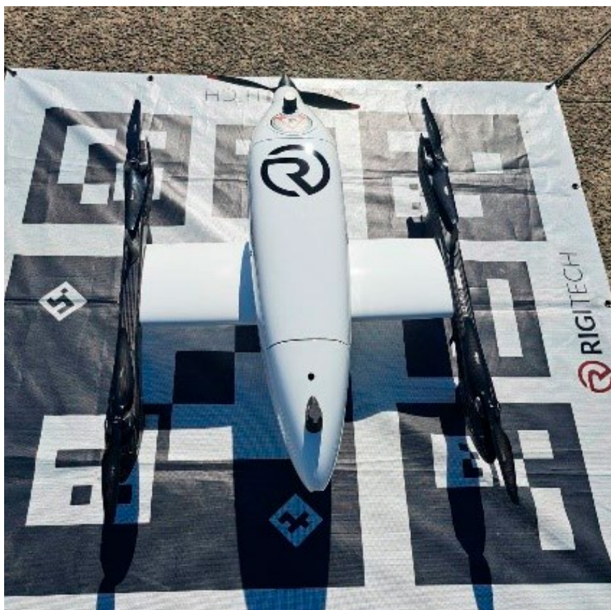
Figura 5. Dron eVTOL utilizado para el proyecto, junto con su base
